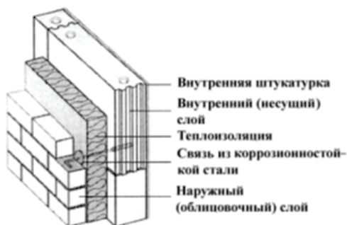
Рисунок 10 – Конструкция со слоем теплоизоляции без воздушного зазора
