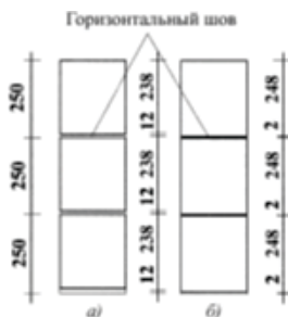
а) – блоки на кладочном растворе; б) – блоки на растворе для тонкошовной кладки, размеры в мм.
