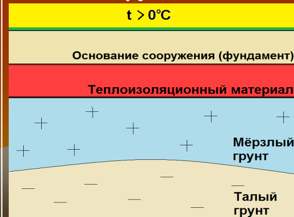
Термостабилизация оснований инженерных сооружений
